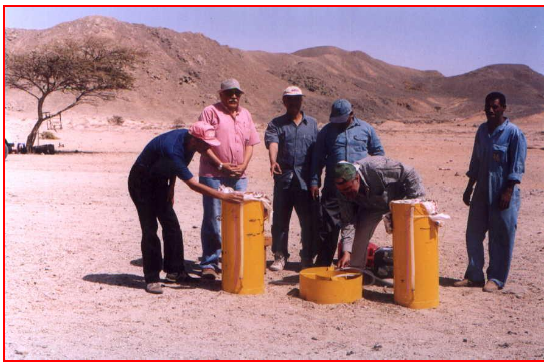
شكل رقم (٩٨) تجربة قياس التسرب الرأسى بوادى غدير
