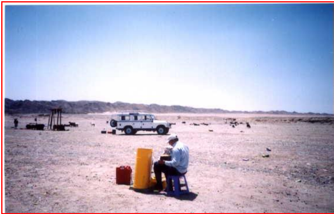
شكل رقم (٩٧) تجربة قياس التسرب الرأسى بوادى غدير
